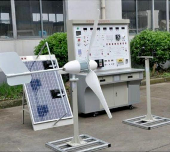
Sobre los paneles se colocan dos reflectores de 500W de intensidad para simular la iluminación solar. El efecto fotovoltaico convierte la energía luminosa en energía eléctrica y carga las baterías a través del controlador.
